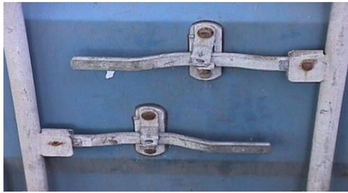
Tipo y color de remache. Remaches nuevos y viejos juntos.
