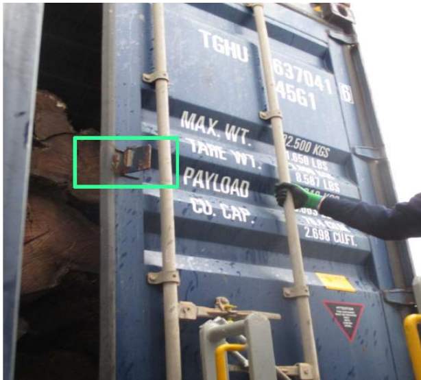
Las placas sólidas no deben cubrir las cavidades de los contenedores estándar.
