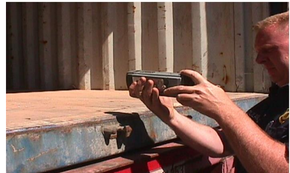
Medición de la longitud del contenedor con láser.
