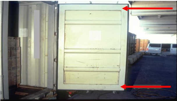
Las placas sólidas no deben cubrir las cavidades de los contenedores estándar.
