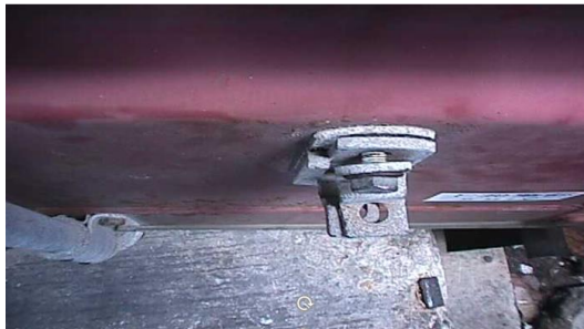
Los pernos desmontables o sueltos pueden permitir el acceso al interior del contenedor.
